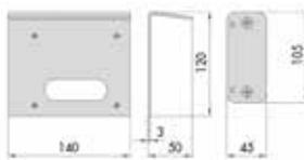
Tettuccio protettivo, sottobocchetta e viti in acciaio zincato. Per serrature serie 11721 - 11726 - 11731 - 11736 - 11761 - 11771 - 11921 - 11931.
