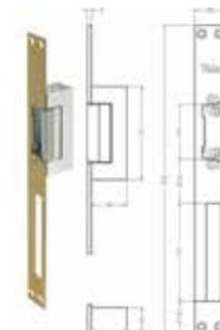
Incontro elettrico con sbloccaggio mediante un impulso elettrico con dispositivo automatico, con frontale in finitura oro, voltaggio 6-12 V. assorbimento da 0,6 a 0,9 A. Ambidestro. Dimensioni frontale 25 X 250 mm. Dimensioni incontro elettrico 28 X 75 mm.
