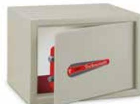
Cassaforte con serratura di sicurezza con chiave a doppia mappa. Spessore porta 4 mm. Spessore corpo 2 mm. Fori di ancoraggio sullo schienale e sulla base (2+2). Verniciatura a polvere termoidurente colore grigio chiaro.
