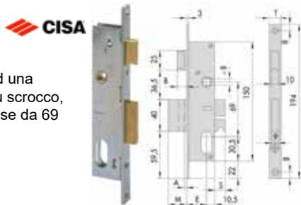
Serratura a cilindro ovale ad una mandata con catenaccio più scrocco, con quadro maniglia interasse da 69 mm.
