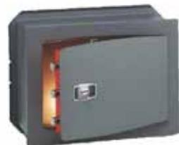
Cassaforte corredata di cilindro europeo con carta di proprietà. Gamma DIN regolabile in 8 posizioni. Catenacci nichelati con diametro di 22 mm. Entrata della chiave protetta da piastrina rotante in acciaio carboniturato per proteggere il cilindro dalla foratura. Alette di ancoraggio sul fondo con funzione antistrappo. Verniciatura a polvere termoindurente con essiccazione a forno.
