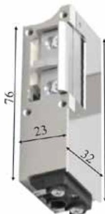
Incontro elettrico per blindato con antiripetitore 8-14 V. Ac, con fermo a giorno inseribile/disinseribile, con pulsante centrale. Compatibile con EFF125ED15.
