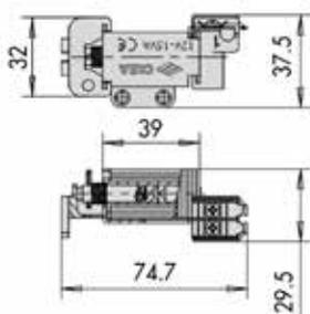
Gruppo bobina. Tensione 12 volt. Per serrature serie 1A610 - 1A611 - 1A630 - 1A631 - 1A721 - 1A731.
