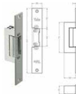
Incontro elettrico con sbloccaggio mediante un impulso elettrico con dispositivo automatico, con frontale in finitura cromosatinata, voltaggio 6-12 V. assorbimento da 0,6 a 0,9 A. Ambidestro. Dimensioni frontale 25 X 160 mm. Dimensioni incontro elettrico 28 X 75 mm.
