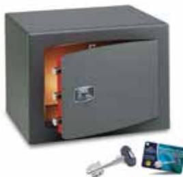
Cassaforte con 8 leve asimmetriche ed indipendenti, certificata UNI EN 1300. Catenacci in acciaio nichelato, girevoli con diametro di 22 mm. Protezione del meccanismo della serratura con piastra in acciaio al manganese. Spessore frontale e porta 10 mm. Spessore corpo 5 mm. Taglio laser. Fori di ancoraggio sulla base e sullo schienale. Verniciatura a polvere termoidurente con essiccazione a forno. Certificata UNI EN 14450 - S2.
