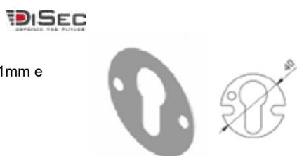
Spessori con interasse di 31mm e diametro di 40 mm.
