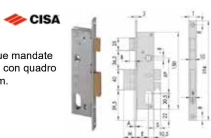
Serratura a cilindro ovale due mandate con catenaccio più scrocco, con quadro maniglia interasse da 69 mm.
