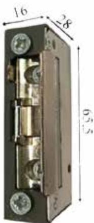
Incontro elettrico con antiripetitore 6-14V. Ac, con fermo a giorno inseribile/disinseribile, con pulsante a levetta centrale. Compatibile con Iseo040030.
