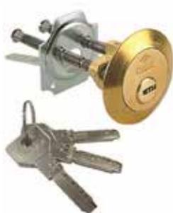
Cilindro con corpo e cilindretti in ottone. Perni e controperni in ottone e in acciaio carbonittrato in prima posizione. Molle in bronzo fosforoso. Camma compatibile DIN, sporgente, in acciaio sinterizzato autolubrificante. Per Serrature 1A610. Riferimento chiave Silca articolo CS70.
