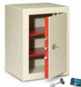
Cassaforte con 8 leve asimmetriche ed indipendenti, certificata UNI EN 1300. Catenacci in acciaio nichelato, girevoli con diametro di 22 mm. Protezione del meccanismo della serratura con piastra in acciaio al manganese. Spessore frontale e porta 8 mm. Spessore corpo 4 mm. Taglio laser. Fori di ancoraggio sulla base e sullo schienale (4+4). Verniciatura a polvere termoidurente con essiccazione a forno.
