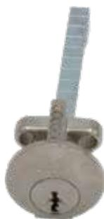
Cilindro con corpo e cilindretti in ottone. Perni in acciaio cementato. Controperni in acciaio temprato a sagoma variabile. Molle in bronzo fosforoso e acciaio. Sistema di cifratura a 6 perni. Camma DIN in acciaio sinterizzato autolubrificante. Per serrature serie 1A610, 11610, 50010, 50130, 50180, 50330, 54310, 54315, 54340, 54510, 54550, 54570.
