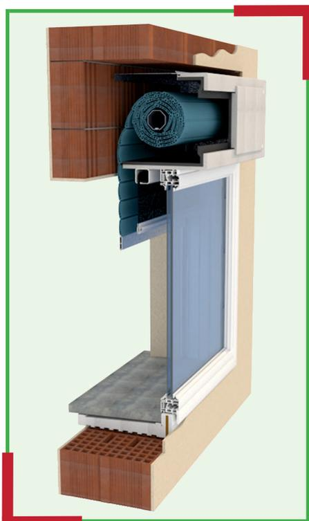
Controtelai a T realizzati su misura in diverse soluzioni e/o combinazioni per adattarsi perfettamente alla dimensione e tipologia del serramento, del cassonetto e della tapparella avvolgibile.
