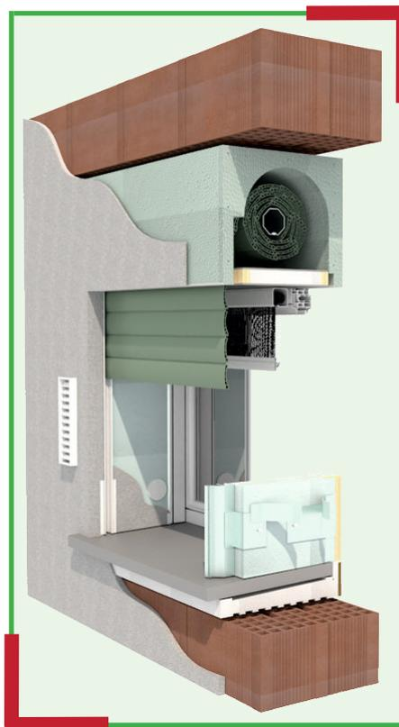
Monoblocco a scomparsa, si adegua a qualsiasi tipologia di muratura, con dimensioni standard della muratura finita 270/305/325/375/395 mm con cassonetto certificato realizzato in polistirolo EPS e celino da 38 mm isolante ed autoportante.
