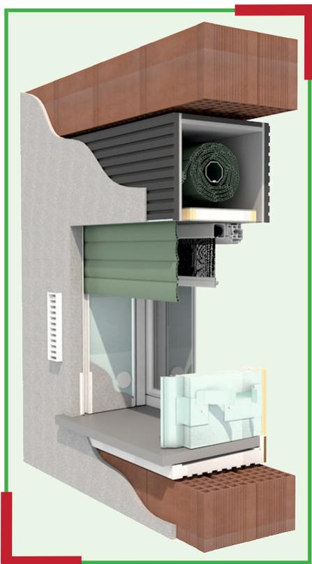
Monoblocco a scomparsa, si adegua a qualsiasi tipologia e dimensione di muratura, con cassonetto certificato realizzato in XPS, rivestimento interno in legno-cemento e celino da 38 mm isolante ed autoportante.
