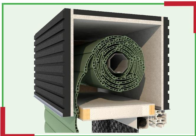
Realizzato in polistirene espanso estruso (XPS) con rivestimento interno in legno-cemento isofone o OSB e bordi inferiori con profili d'alluminio maggiorati atti a determinare il filo malta interno-esterno. La superficie del cassonetto è caratterizzata da scanalature dimensionate al fine di garantire un ottimo sottofondo per l'adesione dell'intonaco o della rasatura
