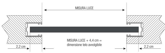
Rilievo misure in larghezza con guide esistenti. Guida in ferro da 22 x 19 mm
