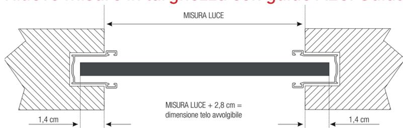
Rilievo misure in larghezza con guide A28. Guida da 28 x 17 mm
