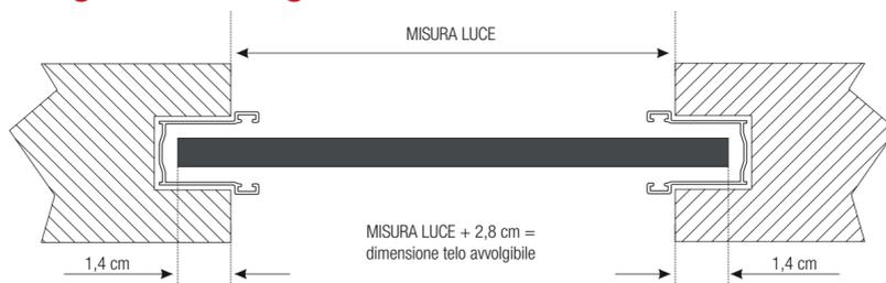
Rilievo misure in larghezza con guide A30. Guida da 30 x 19,5 mm
